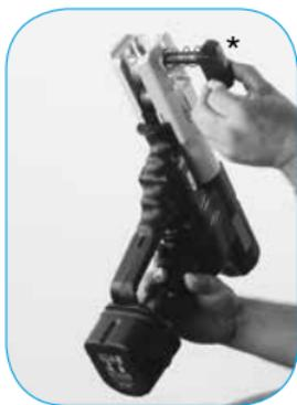
Aprire il perno di ritenuta sulla parte anteriore della macchina premendo il pulsante di rilascio delle ganasce\*.
